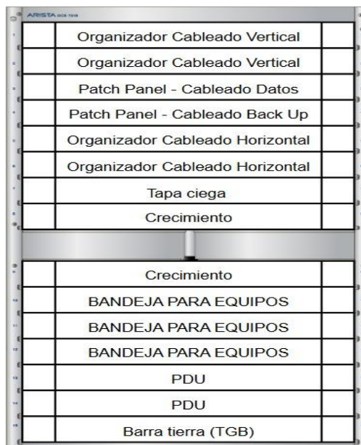
Figura 9. Distribución de RACK 15U
